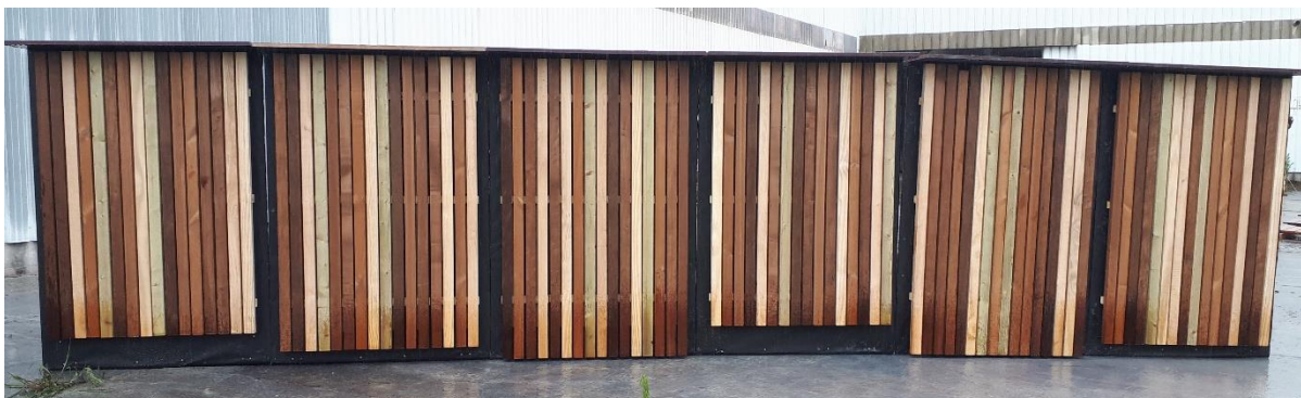
Figuur 7: De opstelling voor gevelelementen met blootstelling van 8 verschillende houtsoorten op drie verschillende hoogtes, al dan niet kops afgedicht.
