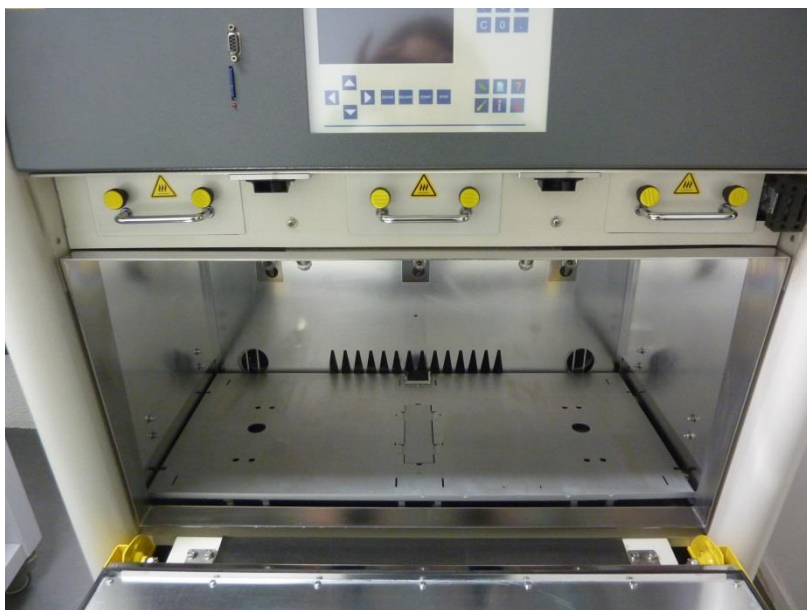
Figuur 2: Binnenaanzicht van de SUNTEST XXL+
