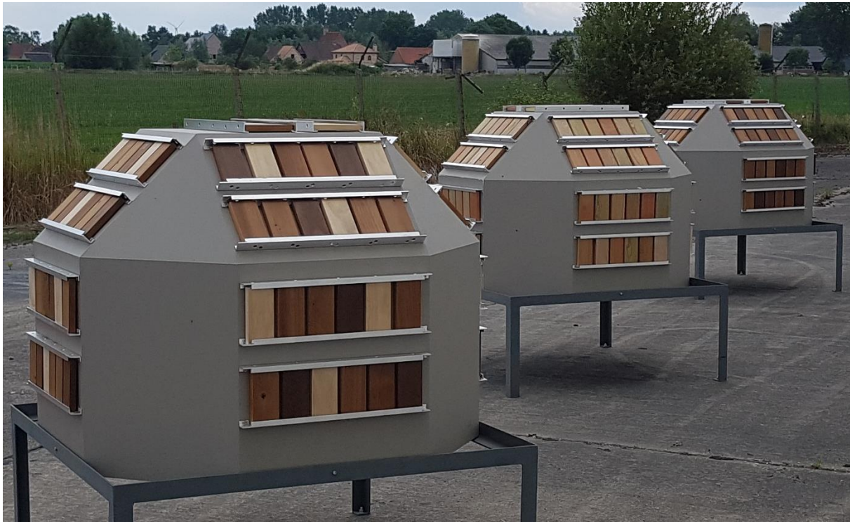
Figuur 6: Drie multifacade exposure rigs zoals opgesteld op het proefterrein.
