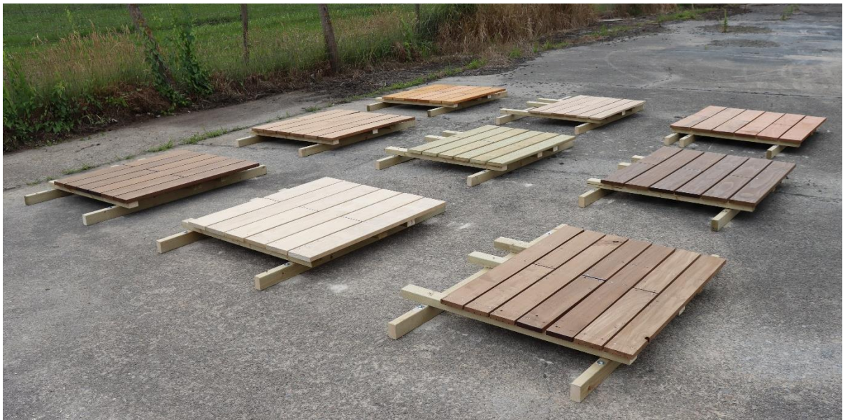
Figuur 8: De opstelling voor terraselementen waarbij 9 houtsoorten werden bloot gesteld.
