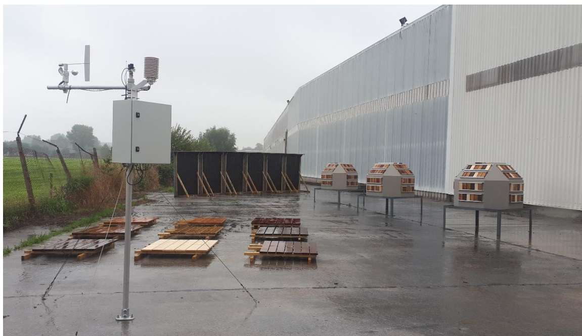
Figuur 4: Overzicht van het proefterrein met de verschillende testopzetten voor de natuurlijke veroudering en het weerstation.
