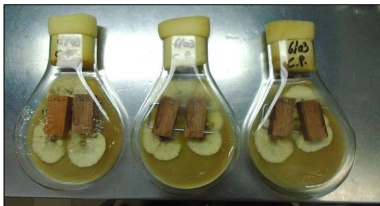
Figuur 9: proefstalen blootgesteld aan een zuivere cultuur van Coniophora puteana (bruinrot)
