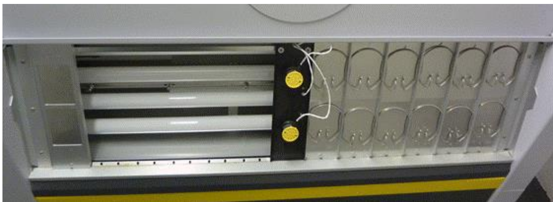
Figuur 1: Binnenaanzicht UV-TEST met stalenhouders (rechts) en vooraanzicht stalenhouder met 2 blootstellingszones (links)
