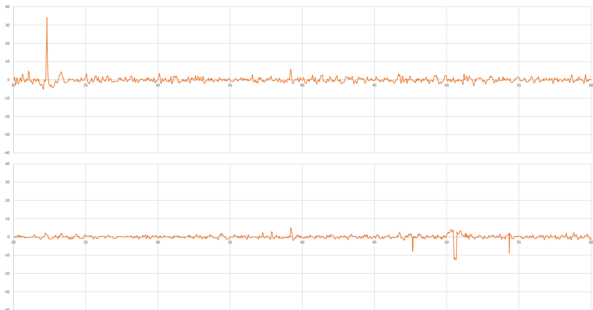
Figuur 37 : Ruwheidsprofiel van proefstuk UV-2 : (a) initieel en (b) na 2 weken verwerking.
