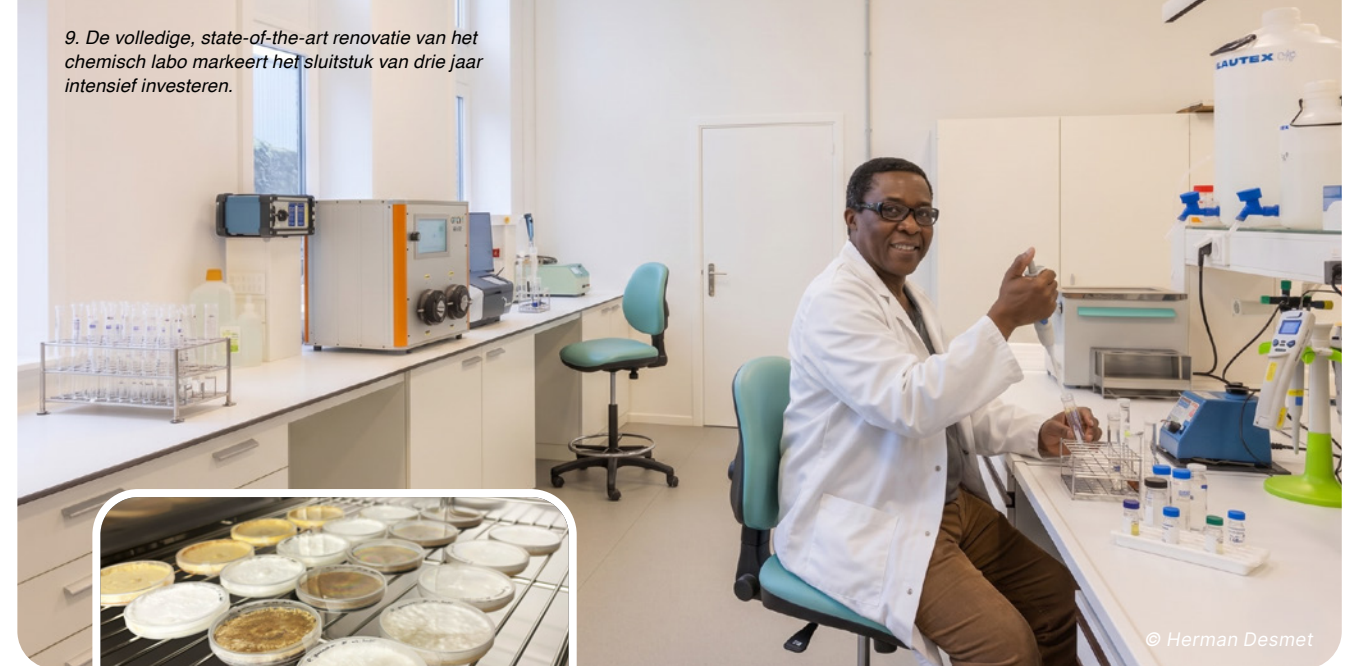
8. In het duurzaamheidslabo testen we de levensduur en weerstand van hout tegen aantasting door houtrotschimmels.
